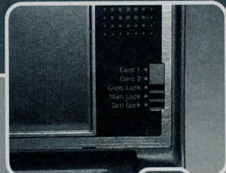
液晶画面の右横にあるステータスインジケータ 液晶画面右横にあるステータスインジケータ。Card 1、Card 2、Caps Lock、Num Lock、Scrl Lockの、それぞれの状態を把握することができる
