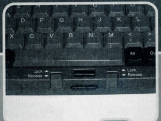
カードスロットのロックスイッチ PCMCIAカードのロックスイッチ。これをロックしないとカードは使用できない
