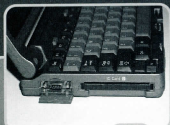
IC Card 2 スロットとシリアルポートコネクタ 本体左側にある IC Card 2 スロットとシリアルポートコネクタは専用仕様となっている
